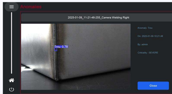
Détection défaut de soudure
